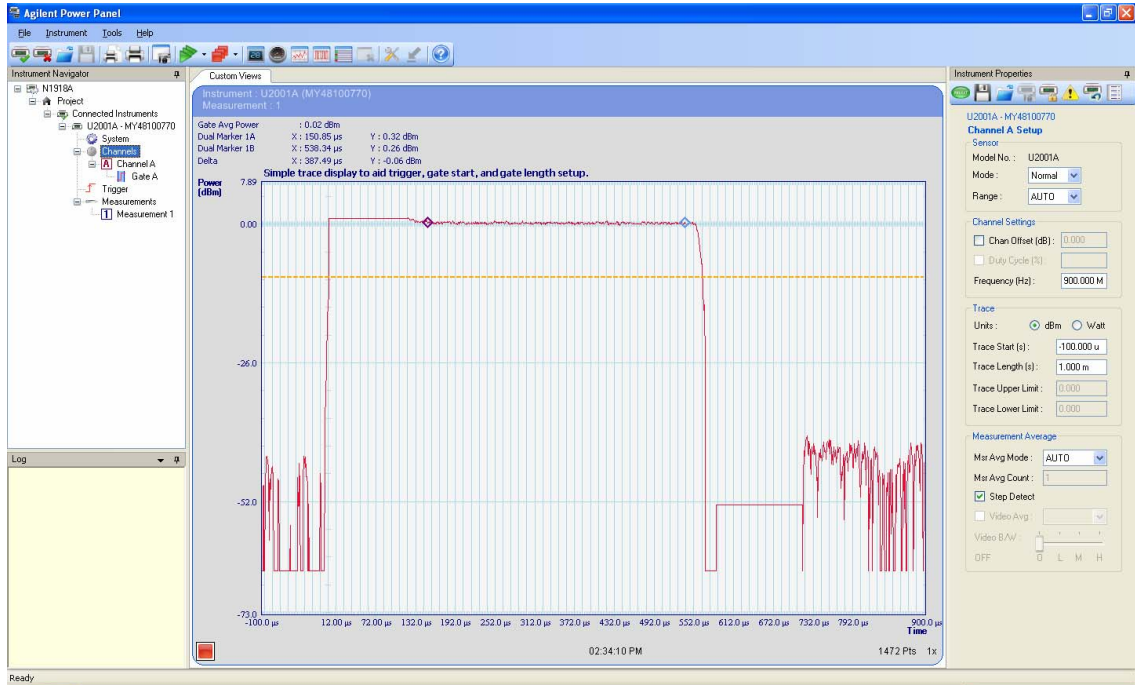
Figure 2-1 Exemple de diagramme de trace pour un signal GSM
